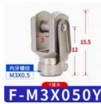
Y型连接件, 衔接 连杆与轴
